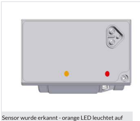
Sensor wurde erkannt - orange LED leuchtet auf
