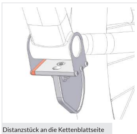
Distanzstück mit drei langen M4 Torx Schrauben befestigen
