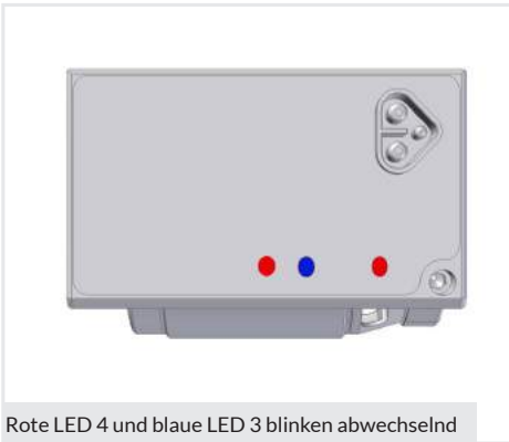
Rote LED 4 und blaue LED 3 blinken abwechselnd
