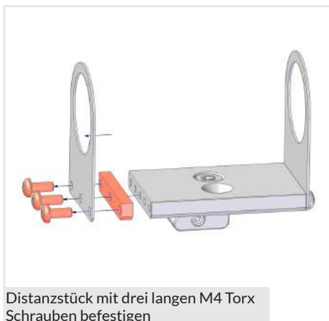
Distanzstück auf die Montageplatte
